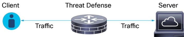
客户端确立与服务器的 TCP 连接后（成功完成 TCP 三向握手后），托管设备会监控 TCP 会话的任何启动加密会话的尝试。TLS/SSL 握手通过使用交换客户端与服务器的专门数据包来确立加密会话。在 SSL 和 TLS 协议中，这些专门数据包称为握手消息。握手消息传达客户端和服务器的加密属性：
