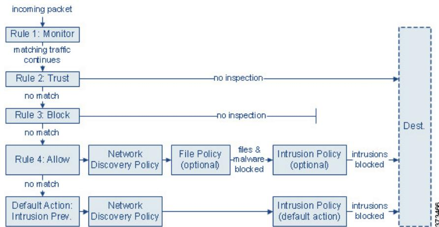
在上面的情景中，策略中的前三条访问控制规则 — Monitor、Trust 和 Block — 无法检查匹配的流量。Monitor 规则跟踪和记录但不检查网络流量，因此，系统继续将流量与其他规则进行匹配以确定是允许还是拒绝该流量。（但是，请参阅[访问控制规则监控操作](#)中的重要例外情况和警告。）Trust 和 Block 规则处理匹配流量，无需任何类型的进一步检查，不匹配的流量继续进入下一条访问控制规则。
