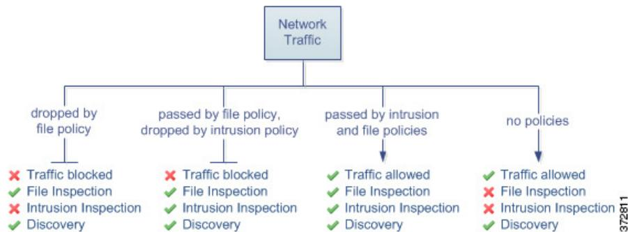
对由访问控制规则处理的任何单个连接，文件检测均发生在入侵检测之前。也就是说，系统不检测文件策略所阻止的文件是否存在入侵。在文件检测中，基于类型的简单阻止优先于恶意软件检测和阻止。
