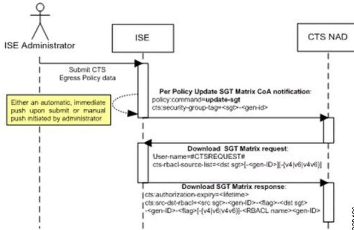
1. 思科 ISE 将更新的 SGT 矩阵 CoA 通知发送到 TrustSec 网络设备。通知包含 SGT 值和生成 ID。
