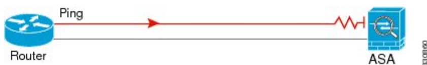
图 4: ASA 没有返回路由引发的 ping 故障
