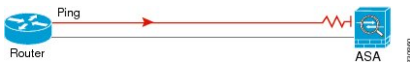
图 4: ASA 没有返回路由引发的 ping 故障
