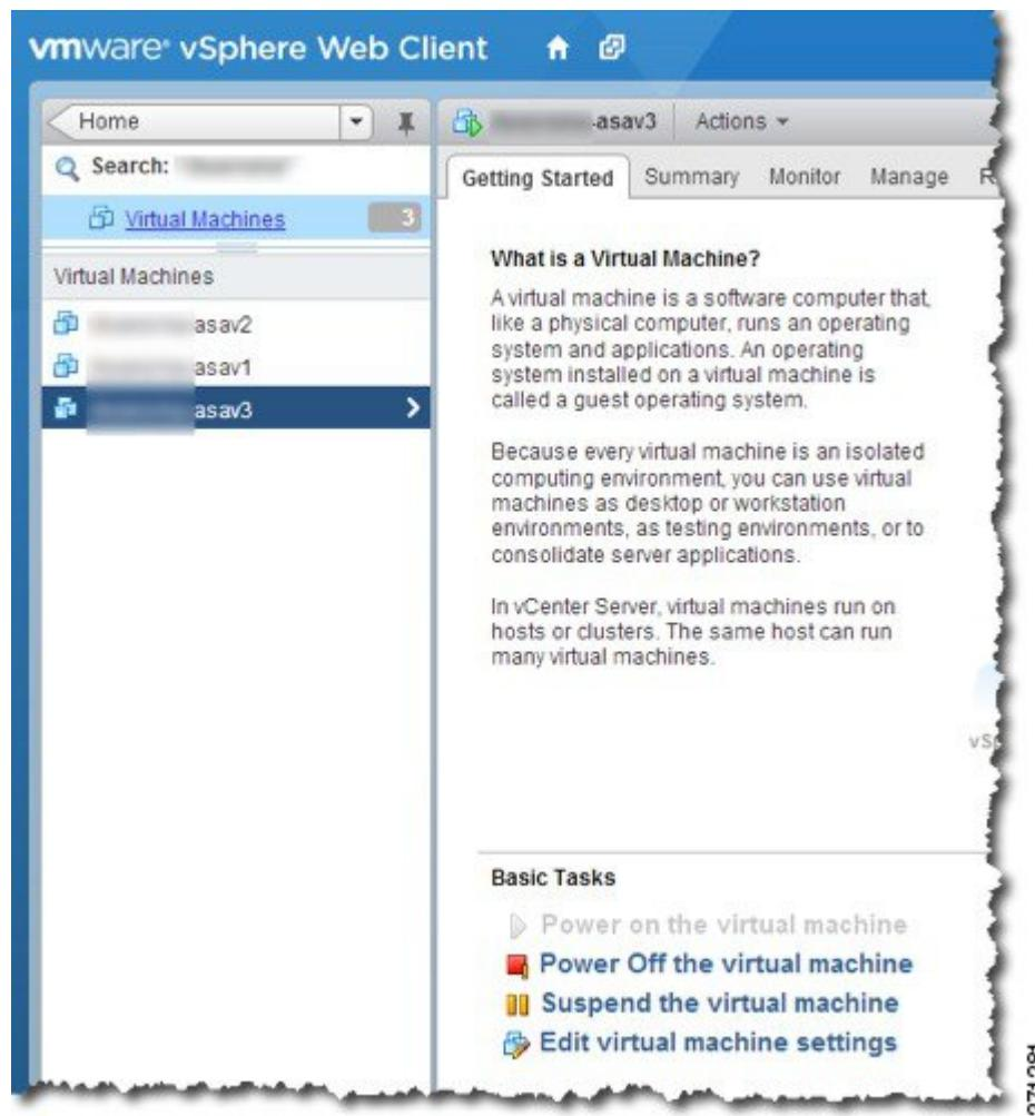
**步骤 10** 如果 ASA virtual 机尚未运行，请点击启动虚拟机 (Power On the virtual machine)。
