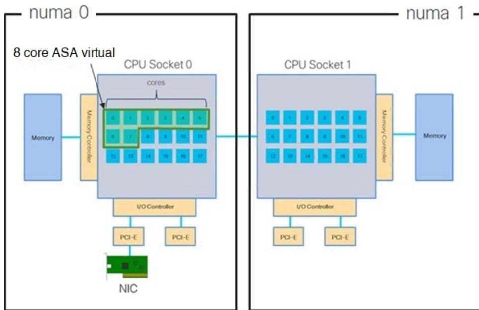
下图显示的服务器有两个 CPU 插槽，每个 CPU 有 18 个内核。16 核 ASA virtual 要求主机 CPU 上的每个插槽至少有 16 个内核。
