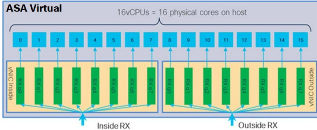
下表显示了适用于 VMware 的 ASA virtual vNIC 以及支持的 RX 队列数量。有关支持的 vNIC 的说明，请参阅[建议的 vNIC](#)，第 2 页。
