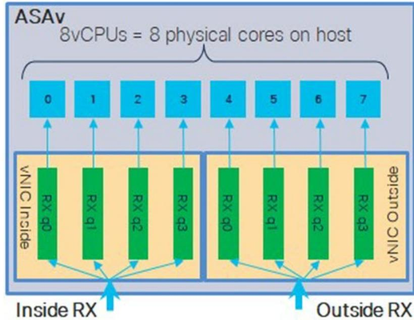
对于具有内部/外部接口对的 16 核 VM，每个接口将有 8 个 RX 队列，如图 4: 16 核 ASA RSS RX 队列，第 21 页中所示。
