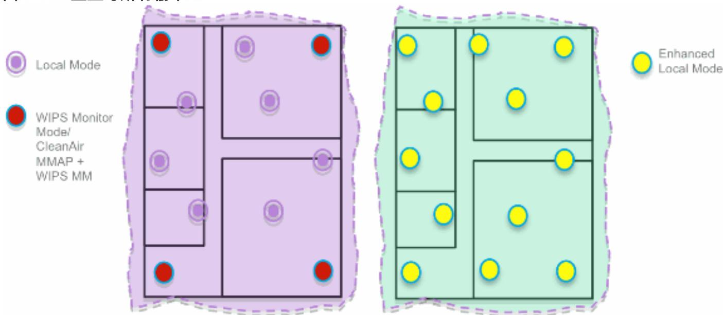
在传统可适应wIPS部署，思科推荐1个MM AP比与每5本地传送方式AP，可能也变化基于最好的覆盖的网络设计和专家指导。通过考虑榆木，管理员启用所有的榆木软件功能现有AP，有效添加MM wIPS操作到本地数据服务模式AP，当维护性能时。
