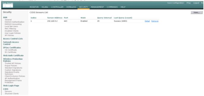
4. 与Cisco IPS传感器建立连接后,请确保WLAN配置正确并启用"客户端排除"。默认客户端排除超时值为60秒。另请注意,无论客户端排除计时器如何,只要IDS调用的客户端块保持活动状态,客户端排除就会持续。IDS中的默认阻止时间为30分钟。
