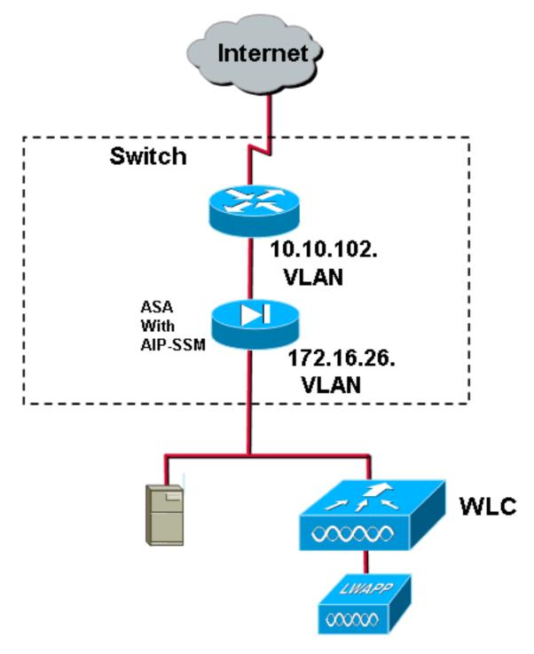
在本例中,使用的ASA已设置并传递流量。这些步骤演示如何创建将数据发送到AIP-SSM的策略。
