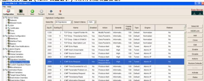
2. 启用签名,将Alert Severity设置为**High**,并将Event Action设置为**Produce Alert**和**Request Block Host**,以完成此验证步骤。请注意,Request Block Host操作是向WLC发出信号以创建客户端异常的关键。
