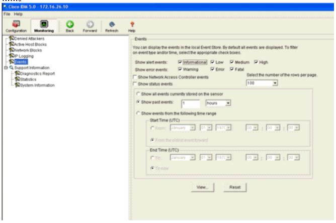
2. 然后,系统将显示事件查看器,其中包含符合给定条件的事件列表。滚动列表,查找在前面的 配置步骤中修改的ICMP回应请求签名。在"事件"列中查找签名的名称,或在"签名ID"列下搜索 签名的标识号。
