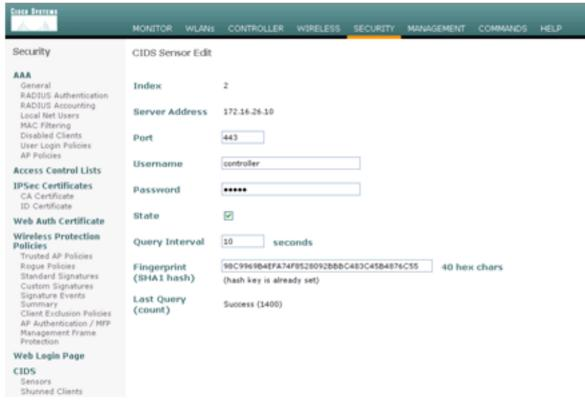
4. 检查AIP-SSM和WLC之间连接的状态。
