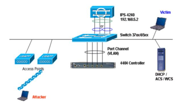
Cisco WLC连接到Catalyst 6500上的千兆接口。为千兆接口创建端口通道,并在WLC上启用链路聚合(LAG)。
