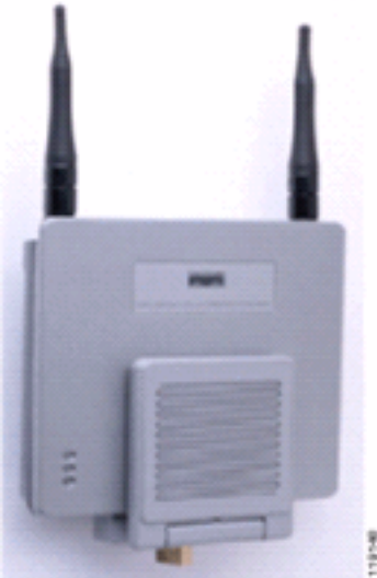
图23 — Cisco AP1200安放对墙壁
