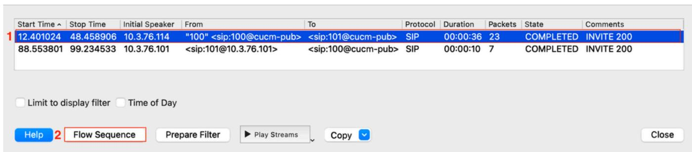
7. Wireshark从设备的角度显示呼叫流程图。确定流程中的网络设备部分，并分析SIP信令，以查找SIP错误或任何呼叫终止或未发起原因的指示。
