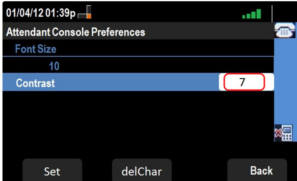
步骤5. 使用电话键盘输入数字以更改显示屏的对比度。数字越大表示显示屏的对比度越高。对比度范围为1-30。
