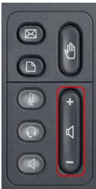
使用音量调节器向上和向下滚动，将振铃器音量调节到所需音量。
