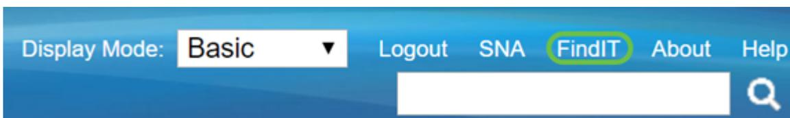
步骤3. ( 可选 ) 访问FindIT网络探测功能的另一种方式是在统一资源定位器(URL)中输入交换机IP地址https://，在交换机IP地址之前输入:4443。在本演示中，我们输入https://192.168.1.113:4443。然后按键盘上的Enter。它应会将您重定向到FindIT Network Probe页面。
