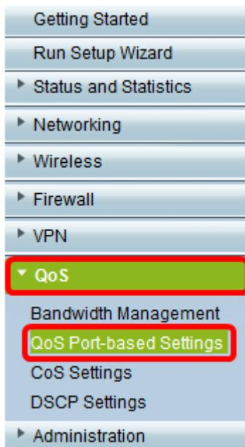
**Step 2.**对于每个端口在QoS基于端口的设置表里，从信任模式下拉列表请选择选项。
