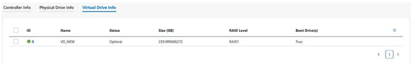
验证虚拟驱动器的另一种方法是通过BIOS。导航到物理/虚拟磁盘信息>虚拟磁盘信息，然后选择虚拟驱动器：
