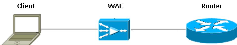
运行IOS防火墙的路由器在WAAS设备之间，看到仅优化流量。ZBF功能注意最初的三通的握手(TCP选项33和序号班次)和它自动调整预计TCP序列窗口(不修改在数据包的序号)。它申请全双工
