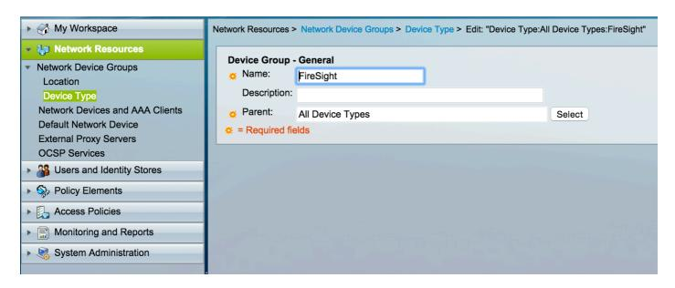
在ACS GUI中,导航至网络设备组,点击网络设备和AAA客户端,然后添加设备。提供描述性名称和设备IP地址。 FireSIGHT管理中心在以下示例中进行定义。
