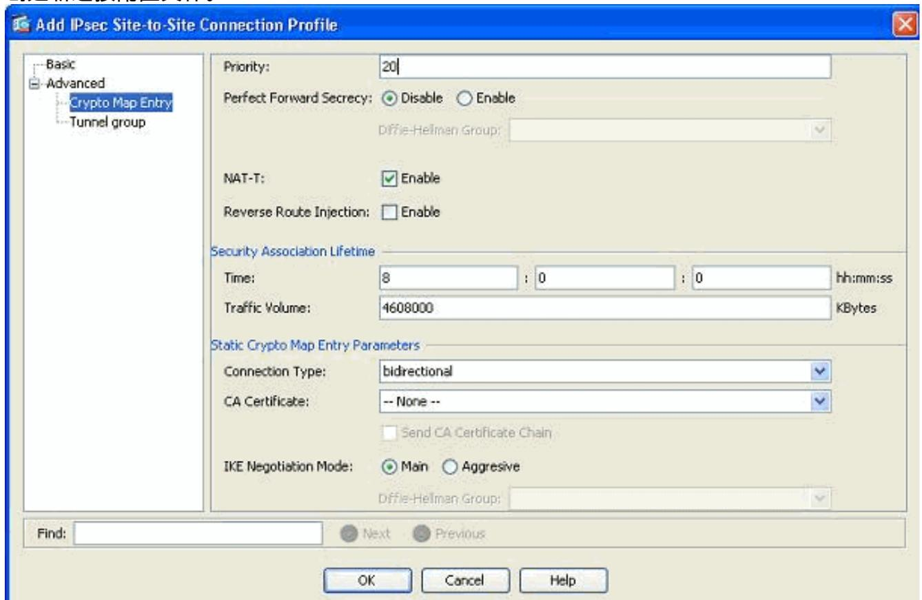
这与一个相关的加密映射一起自动地创建一新的隧道群。在您使用此新连接配置文件前，请确保您能到达BQASA用新的IP地址。
