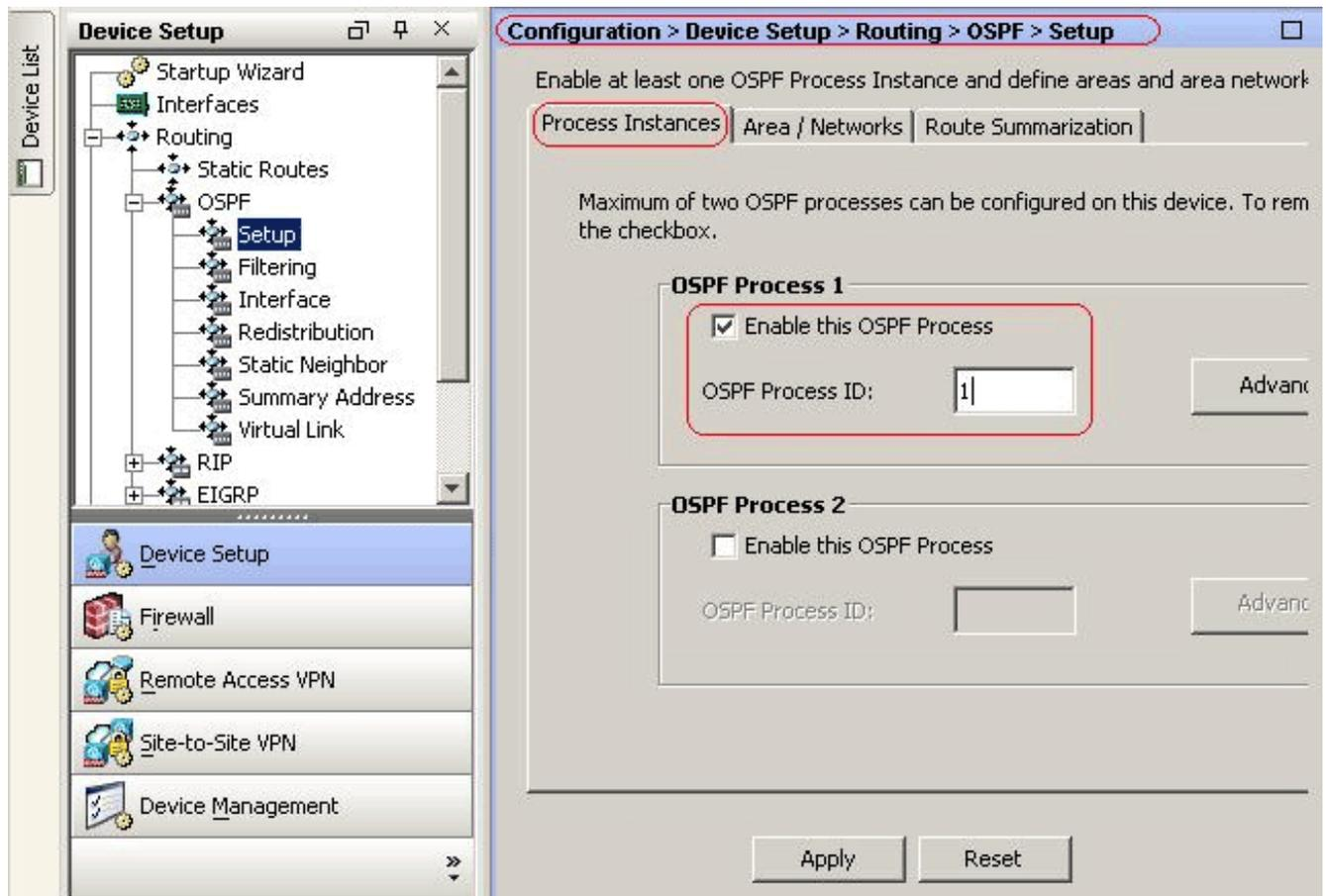
4. 您可以单击 Setup > Process Instances 选项卡上的 **Advanced** 以配置可选的高级 OSPF 路由进程参数。您可以编辑特定于进程的设置，例如 Router ID、Adjacency Changes、Administrative Route Distances、Timers 和 Default Information Originate 设置。
