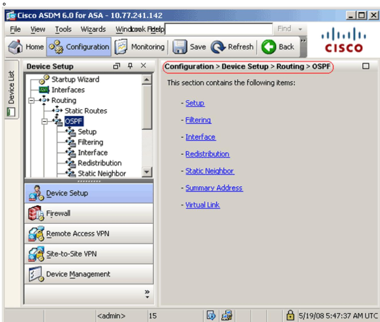
3. 启用 **Setup > Process Instances** 选项卡上的 OSPF 路由进程，如此图中所示。在本示例中，OSPF 进程 ID 是 1。
