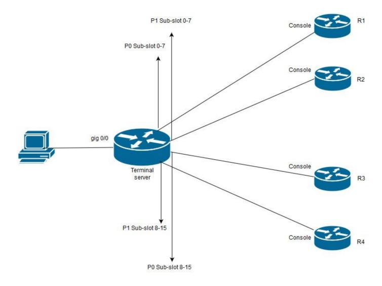
在此图中,Cisco 2911的HWIC-16A卡连接到插槽0,两根八口电缆连接到总共四个设备控制台(每个2个)。 从八口电缆1(0-7)端口0到R1,端口1到R2。同样,从八口电缆2,端口0到R3,端口1到R4。测试PC连接到终端服务器以进行控制台访问。
