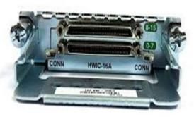
仔细看电缆表示P0、P2、......P7模式中的数字,在卡上,顶部端口的数字为8 - 15,底部的数字为0 - 7。根据上图,您可以说,对于R1,您使用0/0/0行,对于R2线路0/0/1,对于R3线路0/0/8和R4 0/0/9。
