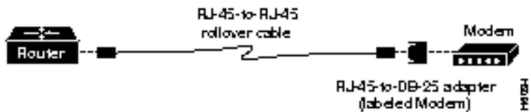
此适配器一端有一台RJ-45连接器，另一端有一个凸头DB-25接头。
