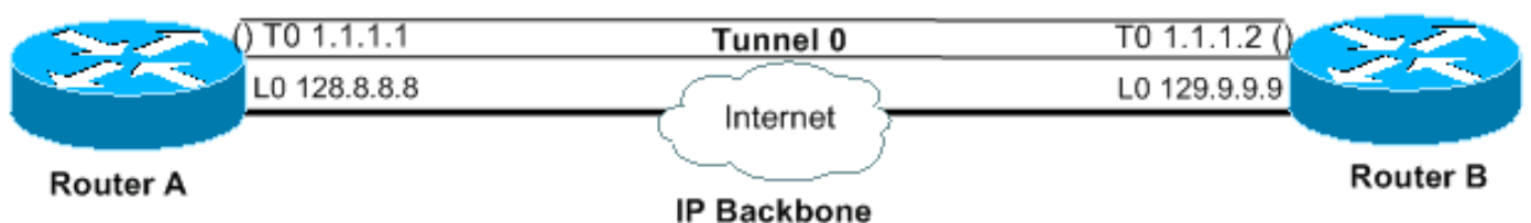
图1 –隧道保活机制的示例
