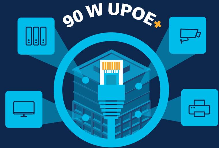
借助 Cisco® Catalyst® 9000 交换机等解决方案提供的 90W 通用型以太网供电+ (UPOE+) 技术，智能楼宇可通过铜质以太网电缆为设备提供直流电源，无需单独的电源和插座。
