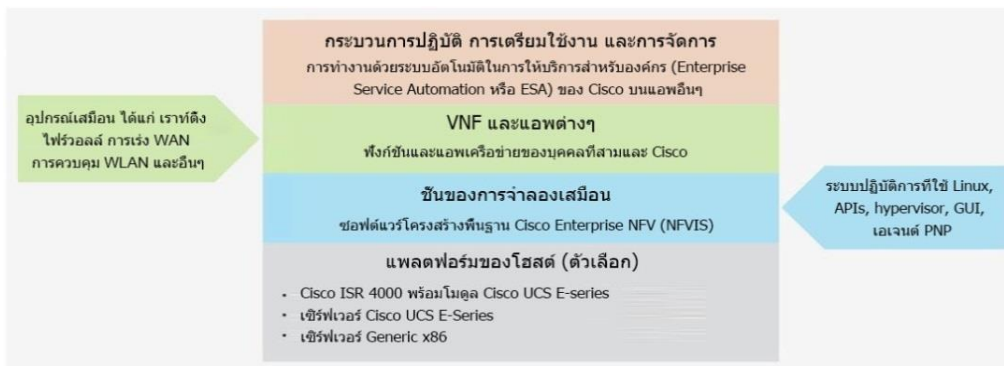
รูปที่ 1. สถาปัตยกรรมของ Cisco Enterprise NFV
