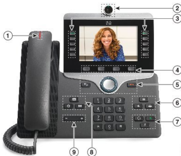
Figura 1: Hardware e teclas do Telefone IP Cisco 8845
