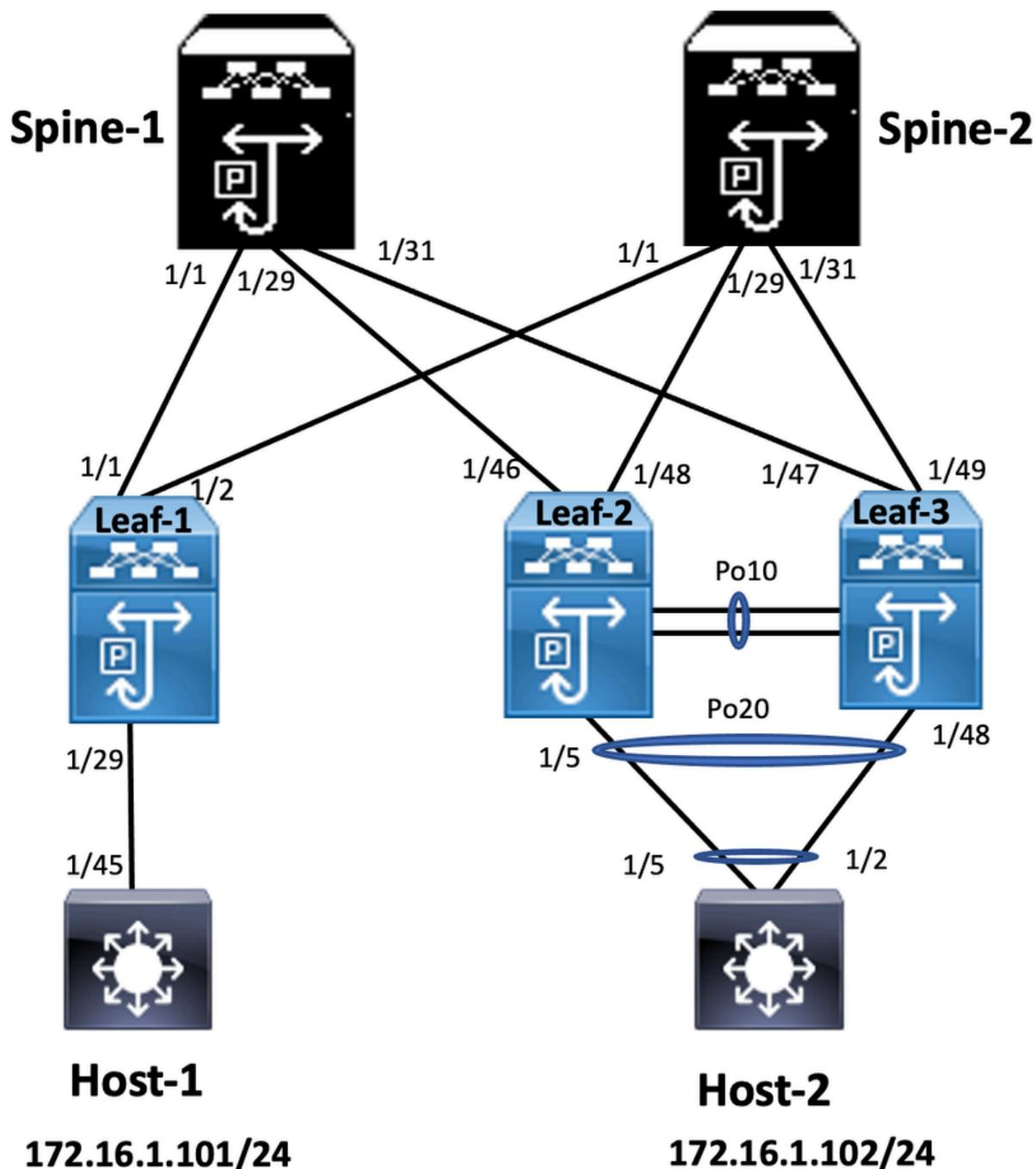
No diagrama, o host se conecta a um par de switches Nexus 9000 e inclui o id de domínio do vPC, mas os switches configurados pelo host não executam o vPC sozinhos. O switch/host de acesso registra o uplink como um canal de porta simples sem conhecimento de vPC.
