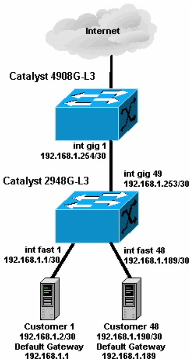
Nesta topologia, o provedor de serviços dividiu em sub-redes 192.168.1.0/24 usando máscaras de sub-rede de 30 bits. Para cada sub-rede, um endereço de host é atribuído a uma das interfaces Fast Ethernet no 2948G-L3 e o outro IP é atribuído ao servidor do cliente. O servidor do cliente 1 está na sub-rede 192.168.1.0/30. Fast Ethernet 1 recebe o endereço IP 192.168.1.1/30 e o endereço IP 192.168.1.2/30 é atribuído ao servidor do Cliente 1.
