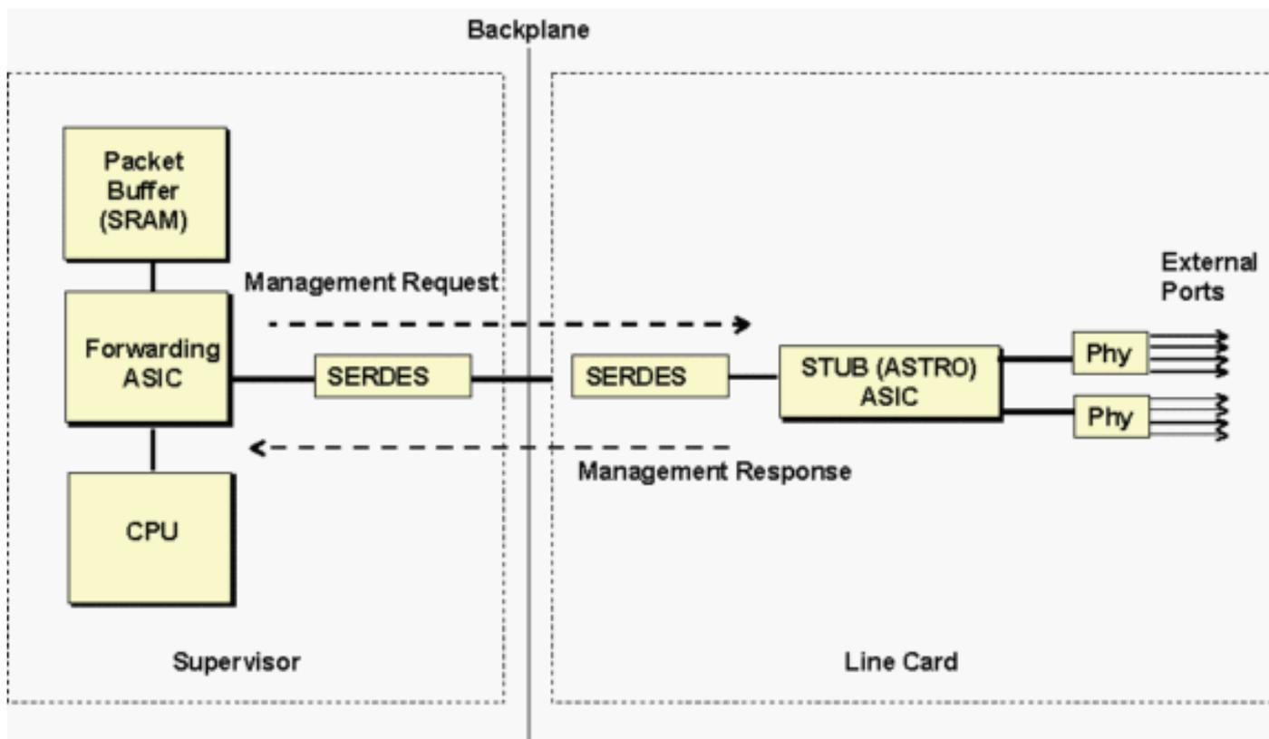
Os supervisores se comunicam com o ASIC do stub da placa de linha por meio do componente SERDES (SERRealizer-DESerializer). Há um componente no lado do Supervisor que se conecta ao painel traseiro e outro SERDES na placa de linha de cada ASIC de stub para se conectar ao painel traseiro.
