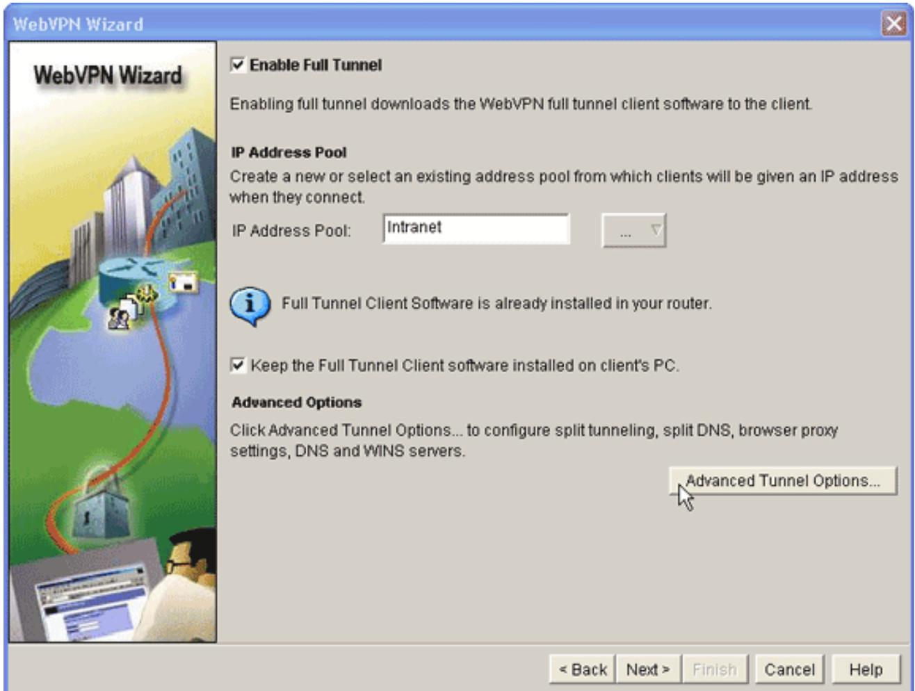
14. Se você quer seus clientes remotos armazenar permanentemente uma cópia do clique SVC o **mantimento o software do cliente completo do túnel instalou na caixa de verificação PC do cliente**. Cancele esta opção para exigir o cliente transferir o software SVC cada vez que um cliente conecta.
