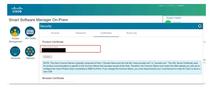
Etapa 4. Depois que o nome do host for confirmado, adicione-o ao ISE no host do servidor SSM On-Prem e clique em<sub>Register</sub>. Após o registro bem-sucedido, o ISE aparece na lista de instâncias de produtos adicionadas à Virtual Account no servidor satélite.
