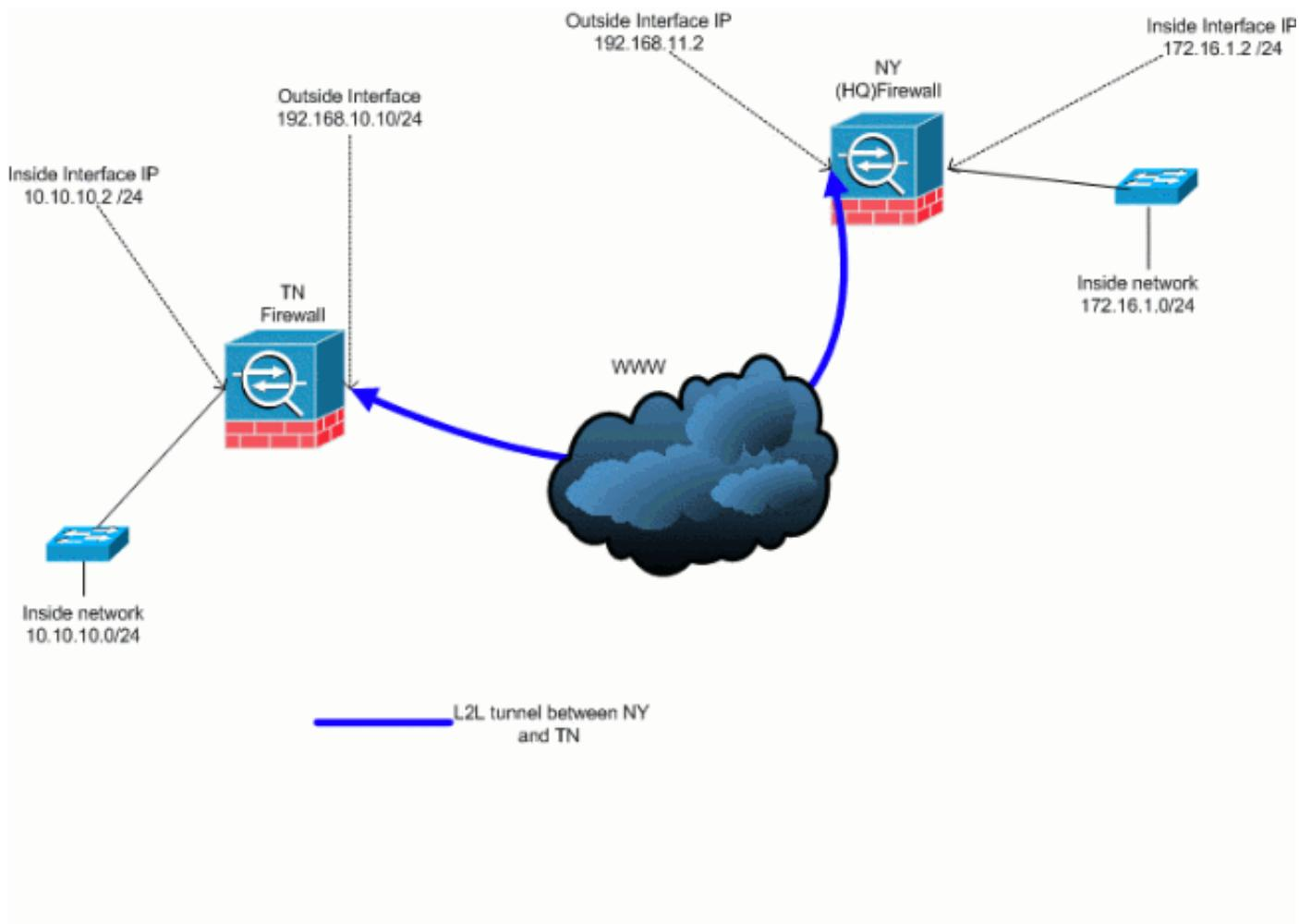
Esta saída é a configuração em execução atualmente da ferramenta de segurança NY (HUB). Nesta configuração, há um túnel do IPsec L2L configurado entre NY(HQ) e TN.
