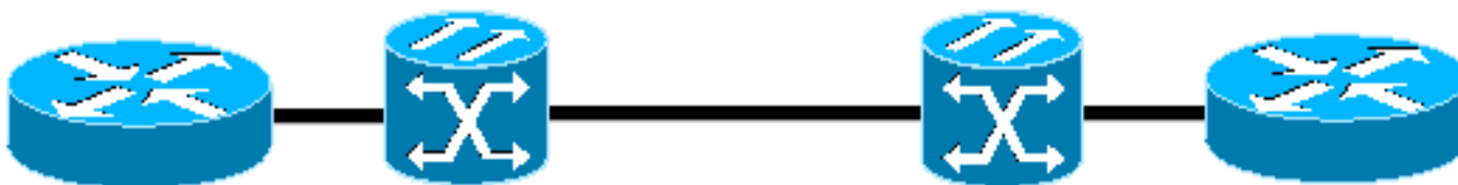
Figura 5 – Rede DWDM não protegida
