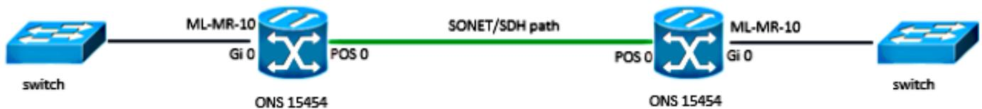
As conexões física são mostradas na topologia. Os cartões ML-MR-10 são instalados em ambos os Nós ONS15454, ML-MR-10 a relação **Gi 0** é conectada com uma relação no interruptor, e é a mesma em ambos os lados.
