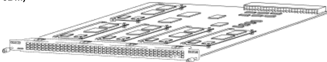
Figura 9 – Placa portadora de mica (AS52-CC-DM) com Módulos MICA dos seis portas (AS52-6DM)
