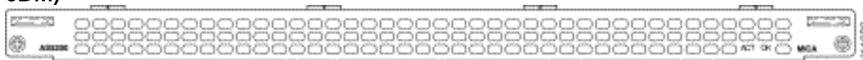
Figura 8 – Placa portadora de mica (AS52-CC-DM) com Módulos MICA dos seis portas (AS52-6DM)
