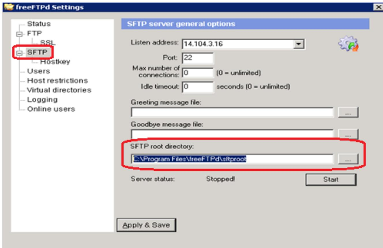
Uma vez que o processo SFTP começa, cria um outro dobrador com o nome da conta sob o trajeto c:\Program Files\freeFTPd\sftproot. À revelia, esse dobrador transforma-se a pasta raiz para essa conta específica.
