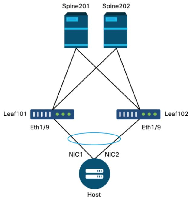
Um servidor da Web está conectado a uma malha da ACI. O servidor Web tem 2 placas de interface de rede (NICs) configuradas em um canal de porta LACP. O servidor Web está conectado à porta 1/9 dos switches leaf 101 e 102. O servidor Web depende da VLAN-1501 e deve residir no EPG 'EPG-Web'.
