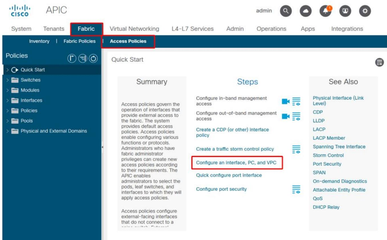
Embora o assistente tenha 'Configurar' no nome, é excepcionalmente útil para fornecer uma exibição agregada das várias políticas de acesso que devem ser configuradas para programar as interfaces. Essa agregação serve como uma exibição única para entender quais políticas já estão definidas e reduz efetivamente o número de cliques necessários para começar a isolar problemas relacionados à política de acesso.
