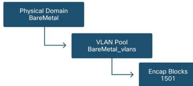
Para a maioria das implantações, um único 'Domínio Físico' é suficiente para implantações bare-metal e um único 'Domínio Roteado' é suficiente para implantações L3Out. Ambos podem mapear para o mesmo "Pool de VLANs". Se a estrutura for implantada de forma multilocatária ou se for necessário um controle mais granular para restringir quais usuários podem implantar EPGs e VLANs específicos em uma porta, um projeto de política de acesso mais estratégico deve ser considerado.
