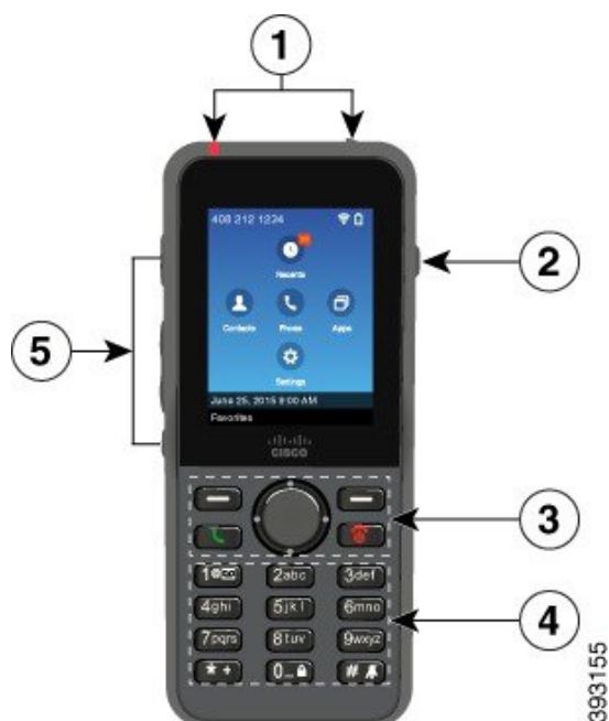
Figuur 2: Cisco draadloze IP-telefoon 8821 Toetsen en hardware
