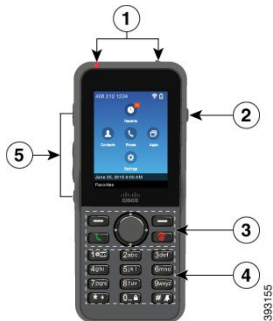
Figuur 2: Cisco draadloze IP-telefoon 8821 Toetsen en hardware
