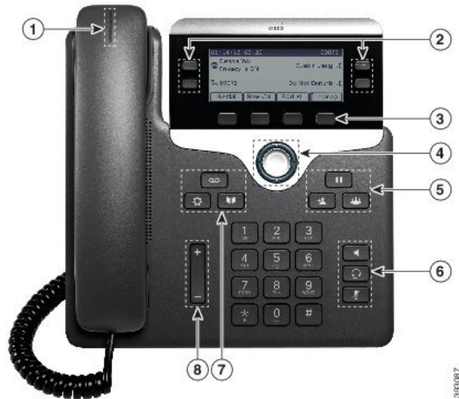
Figuur 3: Toetsen en functies van de Cisco IP-telefoon 7800-serie
