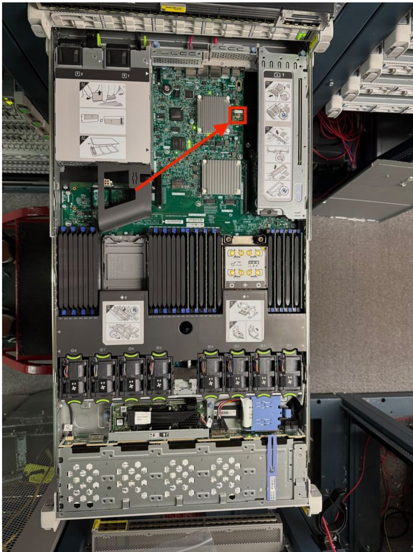
Afbeelding 1. Plaats van de TPM-module in het SNS 3700-toestel
