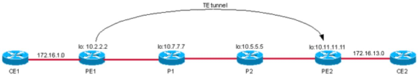
Wanneer de TE-tunnel tussen de PE-routers is gebouwd met automatische aankondiging, is de stap-PE BGP volgende hop bereikbaar via de TE-tunnelinterface. Daarom gebruikt PE1 het TE-label om PE2 te bereiken.
