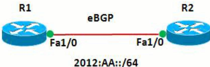
In dit netwerk vormen de routers en R1 en R2 een eBGP-relatie met elkaar. De routers gebruiken OSPFv3 om intern te communiceren. In router R1, wordt het zwart-heiligen bereikt door de configuratie van Null0 op dusdanige wijze dat alle pakketten met bronadres 20:20::20/128 gericht zijn op Null0. Met andere woorden, al het verkeer dat naar Null0 wordt verstuurd, wordt laten vallen.
