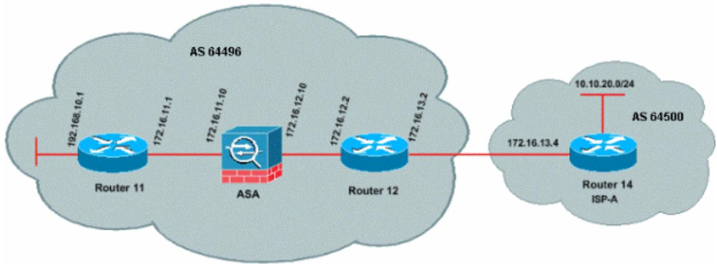
PIX/ASA versie 7.x en introduceert later een extra uitdaging wanneer u probeert een BGP-sessie met MD5 verificatie op te zetten. Standaard wordt PIX/ASA versie 7.x en later herschrijft elke TCP MD5-optie die is opgenomen in een TCP-datagram dat door het apparaat gaat en de optie-type, -grootte en -waarde vervangt door NOP optie-bytes. Dit breekt effectief de BGP MD5 authenticatie uit en resulteert in foutmeldingen zoals deze bij elke peerrouter:
