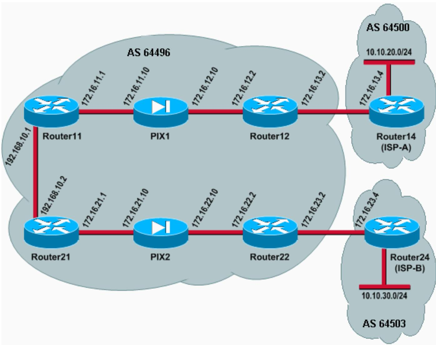
In deze netwerkinstelling worden Router12 en Router22 (die behoren tot AS 64496) naar Router14 (ISP-A) en Router24 (ISP-B) gemultiformeerd voor redundantie. Het interne netwerk 192.168.10.0/24 bevindt zich binnen in de firewall. Router11 en Router21 verbinden met Router12 en Router22 door de firewall. PIX1 en PIX2 zijn niet geconfigureerd voor het uitvoeren van netwerkadresomzetting (NAT).
