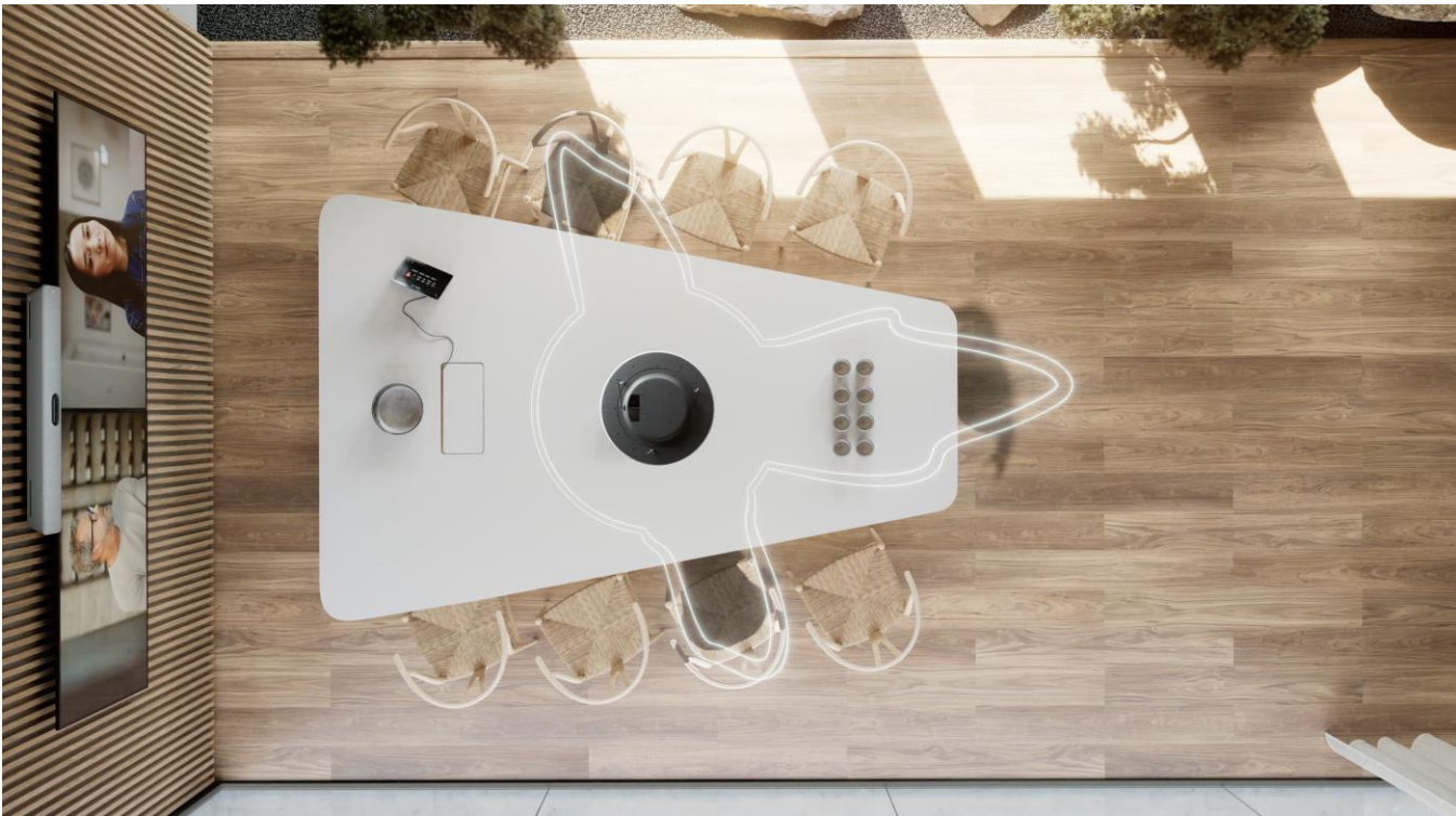
Figuur 5. Adaptieve stralen die de stemmen van deelnemers in een kamer volgen en vastleggen in een middelgrote vergaderruimte.
