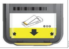
a) 배터리의 아래쪽 가장자리가 배터리함 아래쪽과 가까워지도록 배터리를 잡습니다. 전화기의 금속 접촉부와 배터리가 서로 마주 보는지 확인합니다. 배터리에서 Cisco 로고는 잠금 걸쇠와 가까워야 하고 화살표는 전화기 바닥과 가까워야 합니다.
