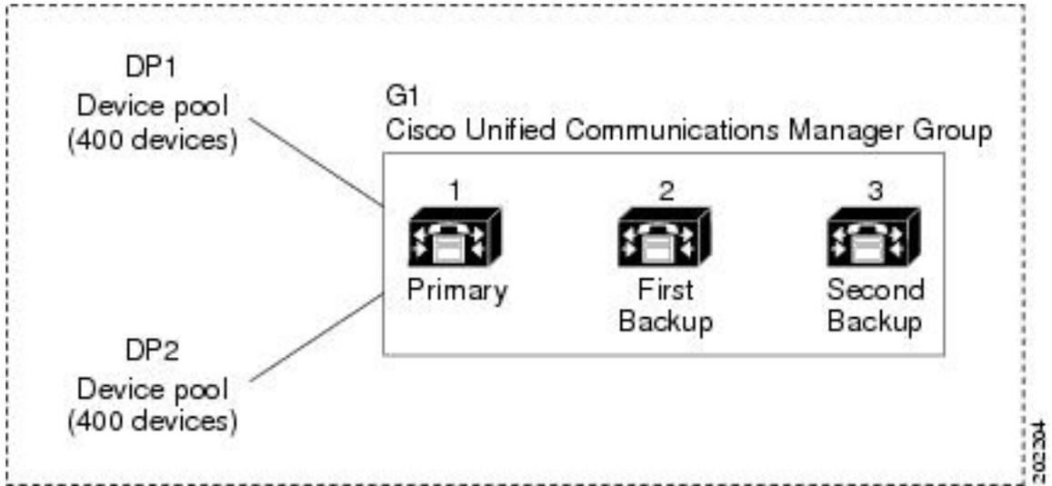
이 그림은 2개의 디바이스 풀, DP1 및 DP2에 할당된 Unified Communications Manager 그룹 G1을 나타냅니다. 그룹 G1의 기본 Unified Communications Manager로서 Unified Communications Manager 1은 정상 작동 시 DP1 및 DP2에서 모두 800개의 디바이스를 제어합니다. Unified Communications Manager 1이 실패하면 모든 800 장치에 대한 제어가 Unified Communications Manager 2로 전송됩니다. Unified Communications Manager 2도 실패하면 모든 800 장치에 대한 제어가 Unified Communications Manager 3으로 전송됩니다.
