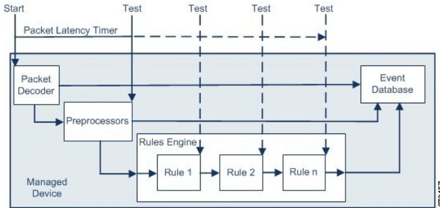
위 그림에 표시된 것처럼, 패킷 레이턴시 타이밍은 다음과 같은 테스트 지점에서 테스트됩니다.
