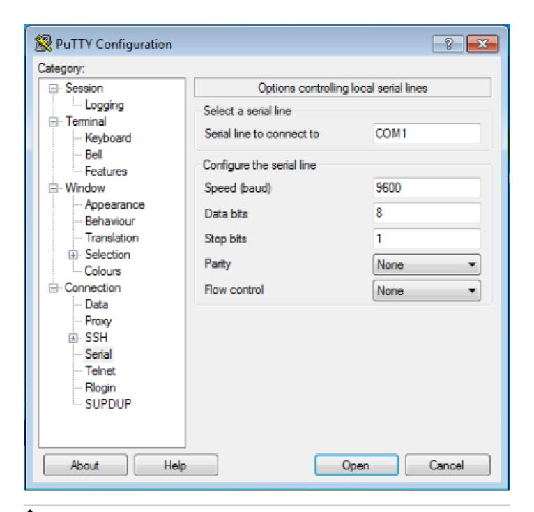
↑ 참고: USB-직렬 어댑터를 사용하여 라우터에 연결을 설정하는 경우 USB 어댑터에 어떤 COM 포트가 제공되는지 확인하고 터미널 에뮬레이터 설정에서 적절한 COM 번호를 선택해야 합니다.
