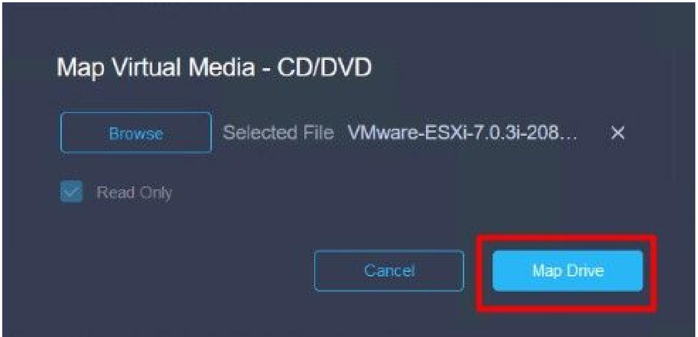
17단계. ISO가 매핑되면 F6 메뉴를 사용하여 ISO에서 부팅합니다. 설치 프로그램이 로드될 때까지 기다립니다. 설치할 스토리지 옵션이 표시되면 원격 iSCSI 스토리지가 표시됩니다.
